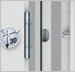
Dreidimensional einstellbare verzinkte Rollenbänder für leichte Türfunktion 3 massive Stahlbolzen auf der Bandseite zum Schutz vor Aushebeln
